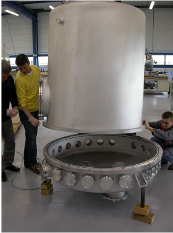
FIGURE 2.3 – Photographie de la cuve à vide lors de la livraison en 2006.
