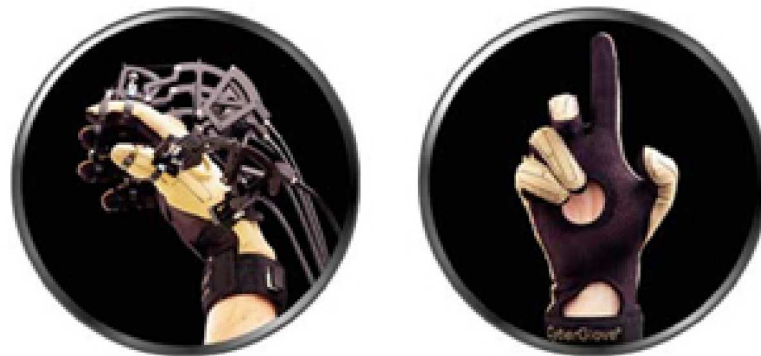
Figure 2.7. Le gant à retour d'effort CyberGrasp (à gauche), et le gant tactile CyberGlove (à droite) – Immersion Inc.
