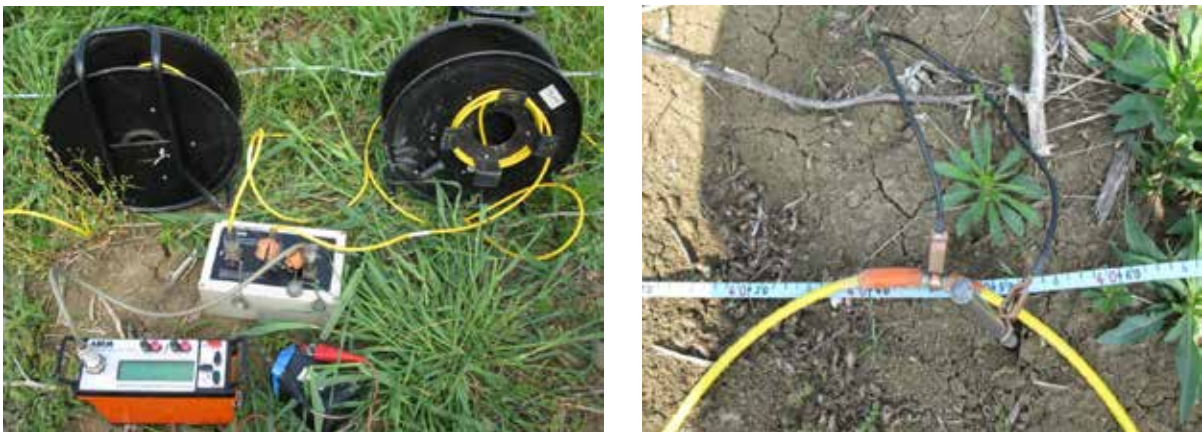
Photographie 2 : L'installation pour la mesure de la résistivité électrique (à gauche le Terramètre, à droite le raccordement d'une électrode)
