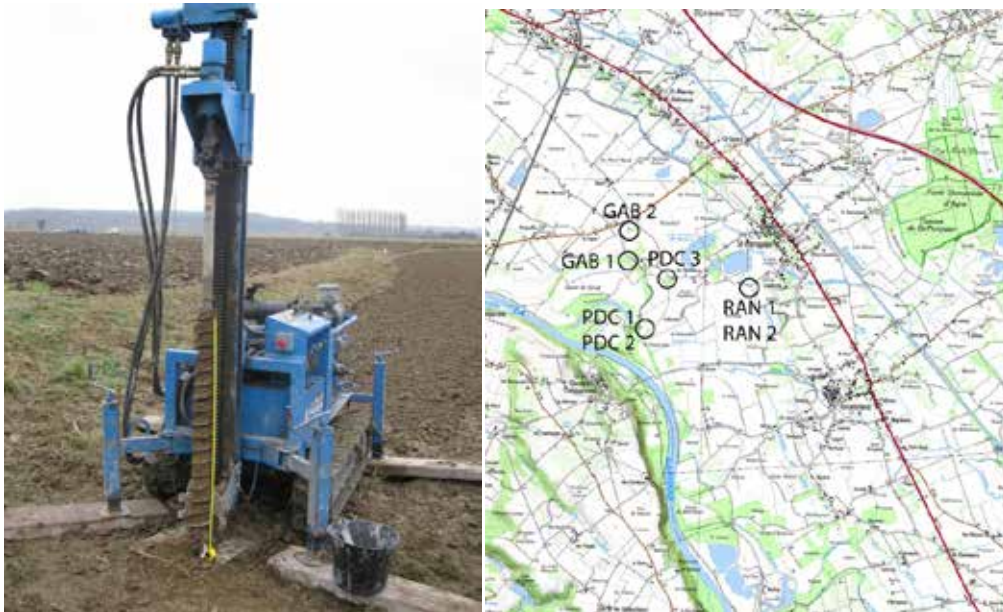
Figure 17 : à gauche, plateforme de carottage APAGEO 23D. A droite, localisation des sondages dans le secteur de Saint-Porquier
