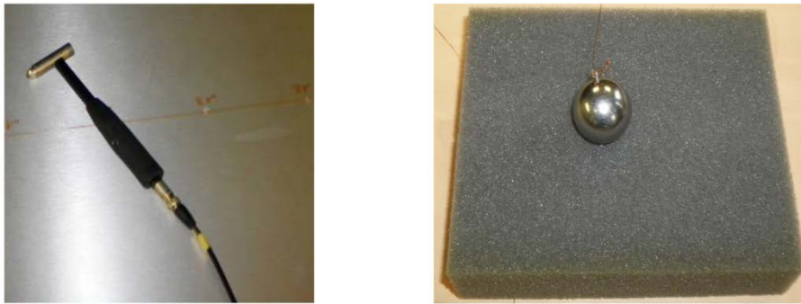
Figure 3-2 : Marteau de choc (à gauche) et bille en acier inoxydable (à droite) utilisés pour générer les excitations transitoires
