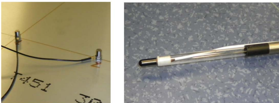
Figure 3-3 : Accéléromètres (à gauche) et hydrophone (à droite) utilisés pour les mesures
