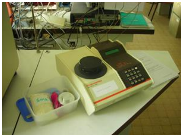
Figure 13: pycnomètre à Hélium. Détermination de la masse volumique du squelette de silice
