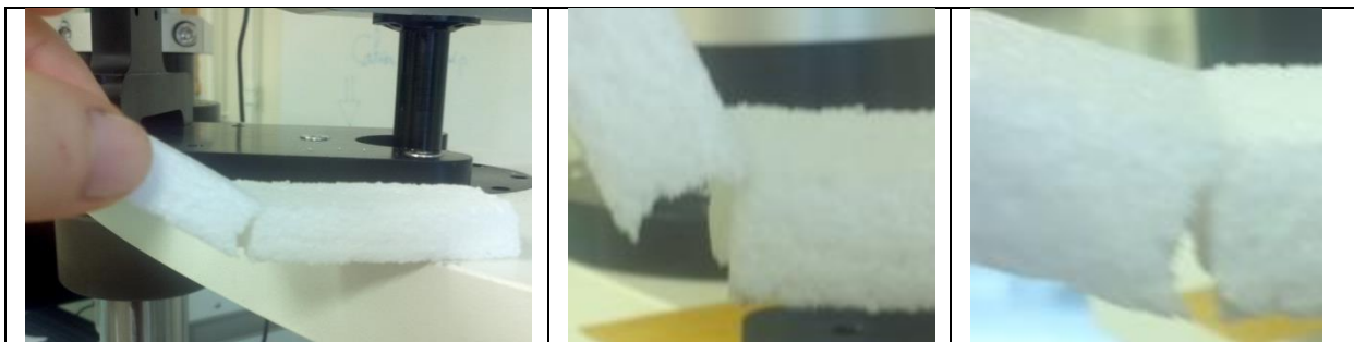
Figure 27 : composite, structure stratifiée : film supérieur/composite granulaire/film inférieur
