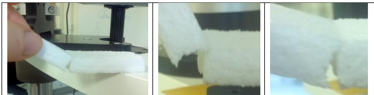
Figure 27 : composite, structure stratifiée : film supérieur/composite granulaire/film inférieur
