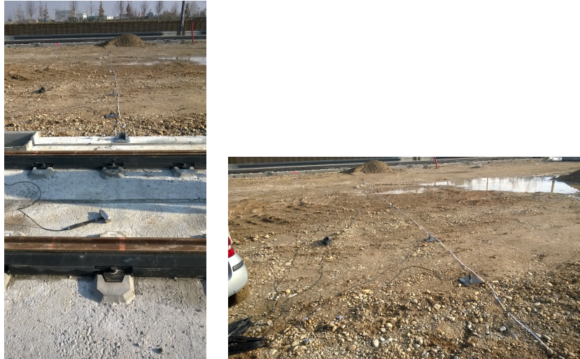
FIGURE 2.38 – Photos de l'expérience de décroissance avec impact sur dalle de "Décines Grand Stade"
