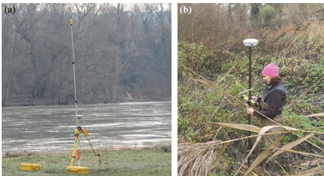
**Figure 2.11. Matériel utilisé pour les acquisitions topographiques de précision réalisées sur les bouchons alluviaux et les têtes de puits piézométriques : le GPS différentiel comprenant (a) un récepteur de base et (b) un récepteur mobile.**
