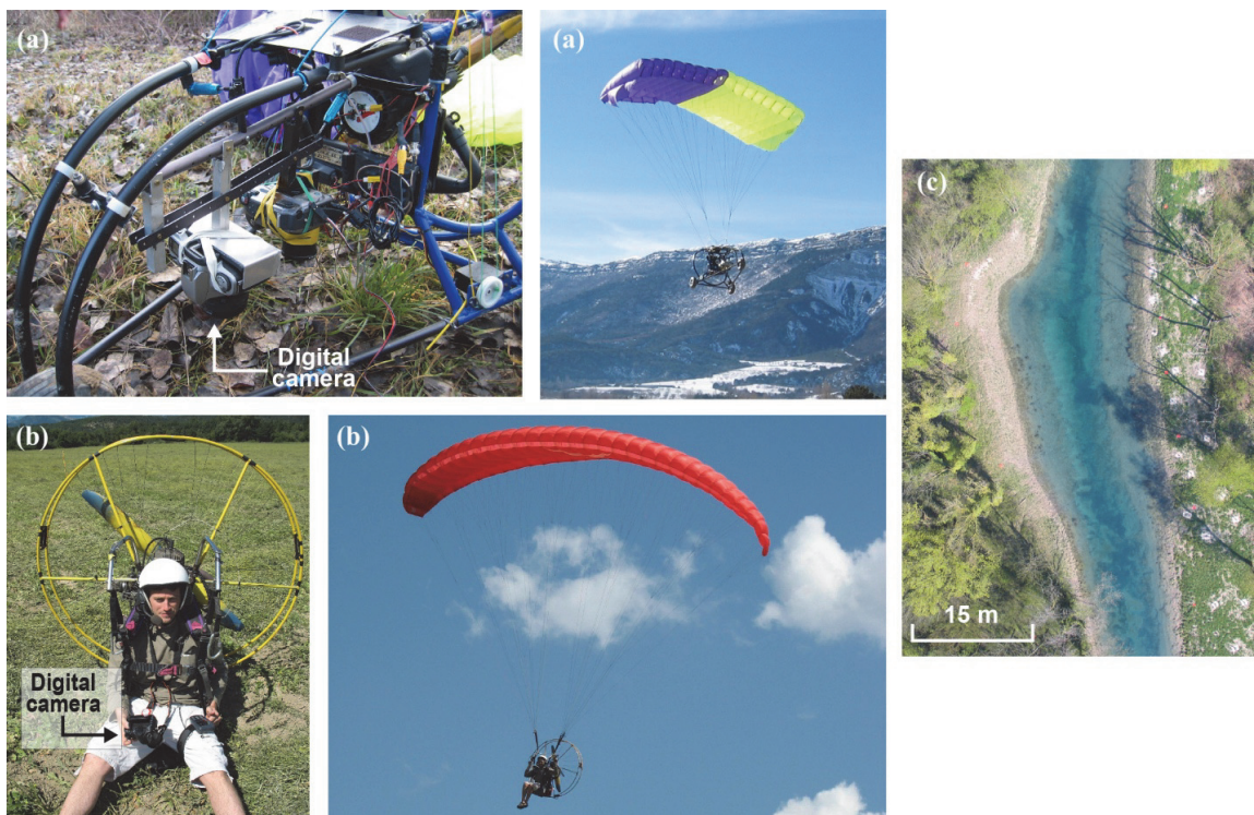
Figure 2.9. Moyens techniques mis en œuvre pour l'acquisition d'images à très haute résolution spatiale de la zone aquatique de la lône de la Malourdie (vieux-Rhône de Chautagne) : acquisitions aéroportées à partir (a) d'un drone "Pixy" ou (b) d'un paramoteur et (c) exemple d'une image brute obtenue (résolution de 4 \text{ cm.px}^{-1} ; campagne de 2007).
