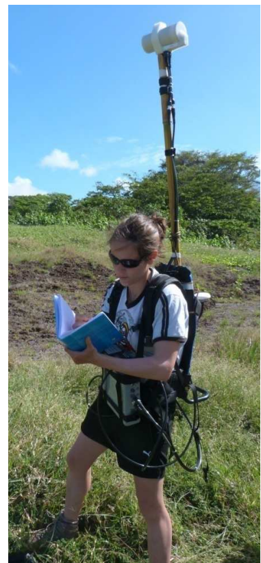
Figure 3.44 : Réalisation des mesures sur le terrain (2012) à l'aide du GSM-19 portable.
