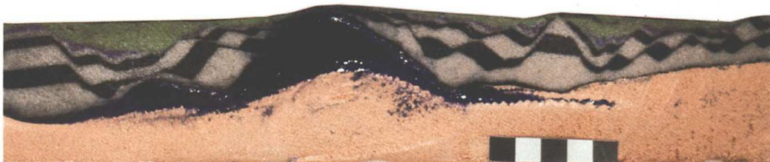
Figure 3.31 : d'après Brun et al., 1994. Résultat d'une expérience d'extension dans un analogue de croûte représentée initialement par des couches de sable reposant horizontalement sur une couche de silicone.
