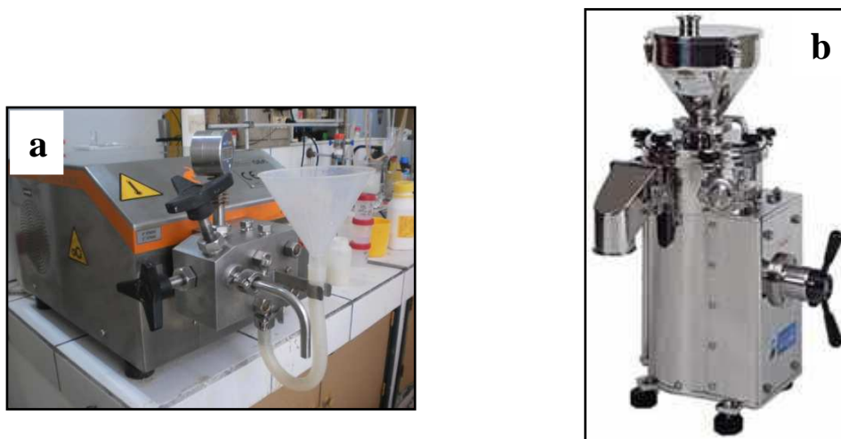
Figure 5. Schéma d'un homogénéisateur à haute pression (a) et d'un broyeur «Masuko grinder» (b).
