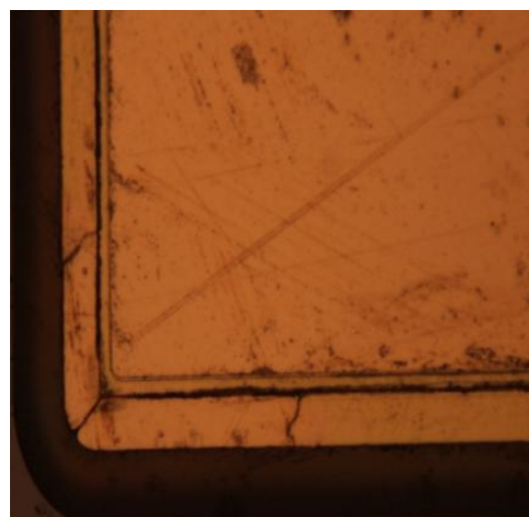
Figure 81 : Délaminages à l'interface Si / BCB et fissures au coin de la diode DT 2 .
