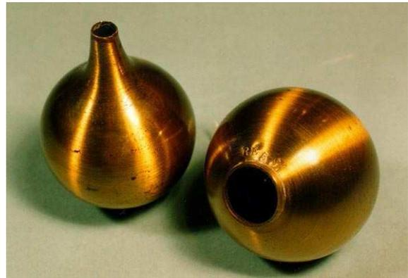
**Figure I.11.** Résonateurs de Helmholtz en laiton verni. Instruments d'étude qui avaient pour but d'amplifier certaines fréquences caractéristiques provenant du bruit environnant et dépendant du rayon de la sphère<sup>7</sup>.
