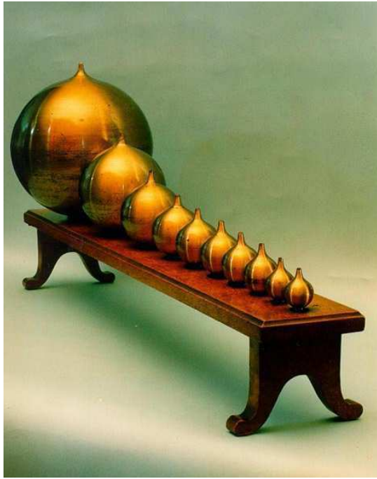
Figure I.11. Résonateurs de Helmholtz en laiton verni. Instruments d'étude qui avaient pour but d'amplifier certaines fréquences caractéristiques provenant du bruit environnant et dépendant du rayon de la sphère 7 .
