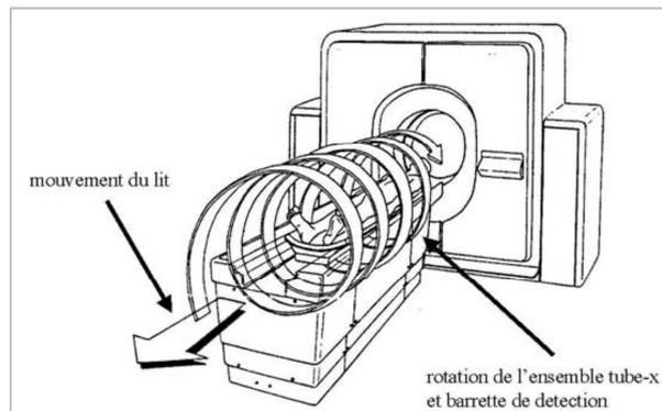
Figure 11 Illustration du faisceau d'irradiation en mode d'acquisition hélicoïdale
