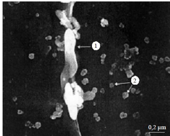
Figure 1.6 Carbures observés au MEB dans l'acier de cuve, ① sur les anciens joints de grain austénitiques et ② dans la ferrite, [Carassou 2000].
