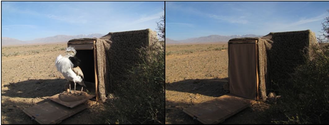
Figure 14: Dispositif de diffusion comprenant le haut-parleur et le leurre visuel sorti de sa boîte à gauche et rentré à droite.
