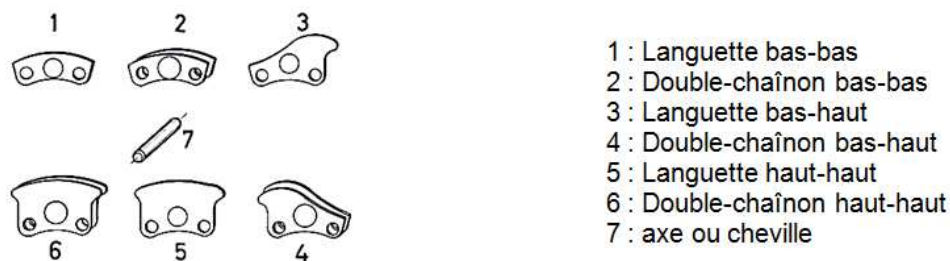
Figure 5. 2: Composition de la chaîne à maillons
