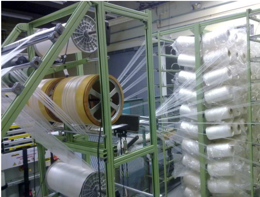
Figure 5. 11 : Encantrage et montage des ensouples
