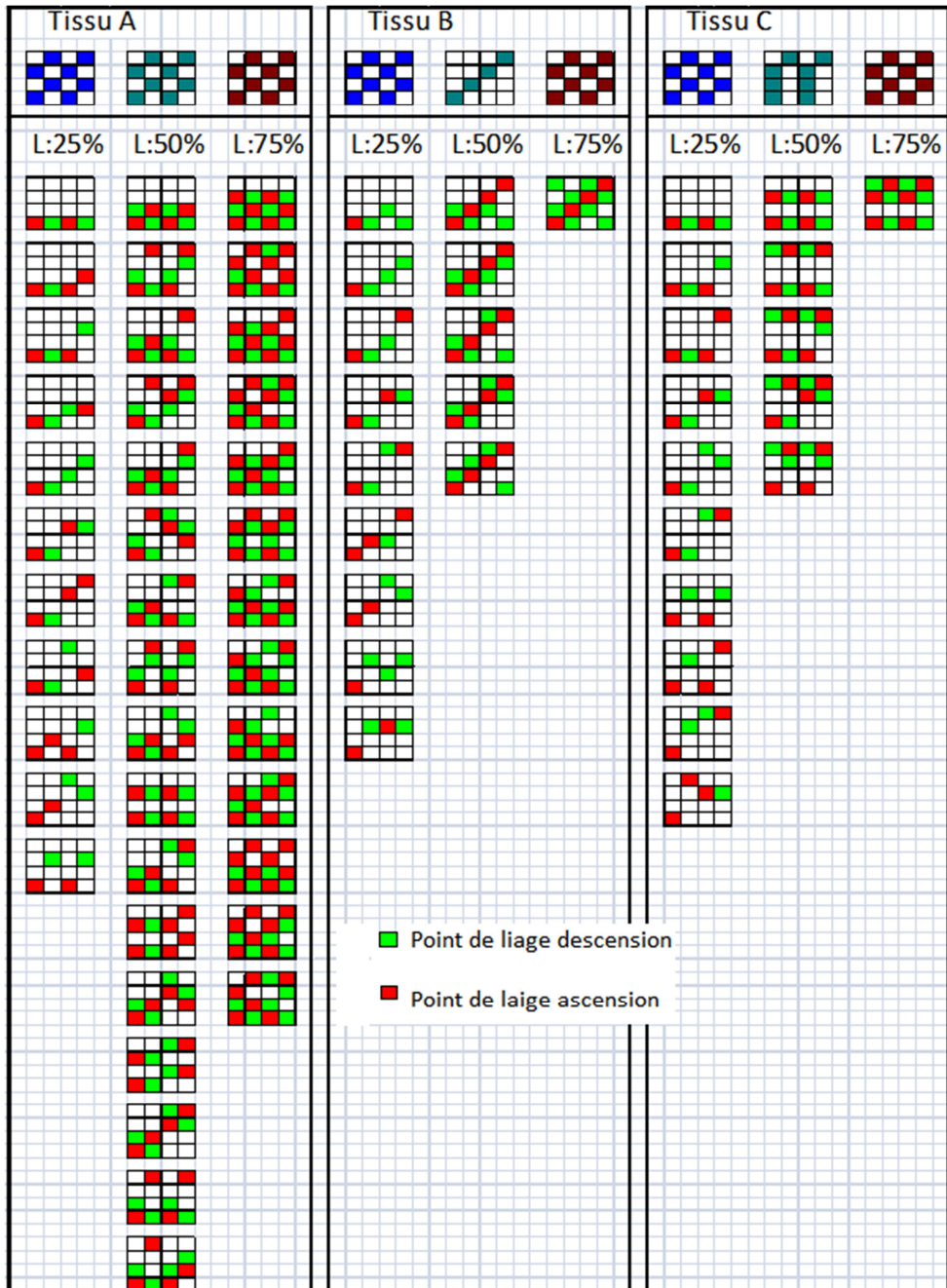
Figure 5. 15: Les armures de liages générés par le logiciel pour les armures données
