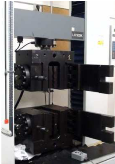
Figure 6. 23 : Dynamomètre LLOYD LR 100K de chez COBRA
