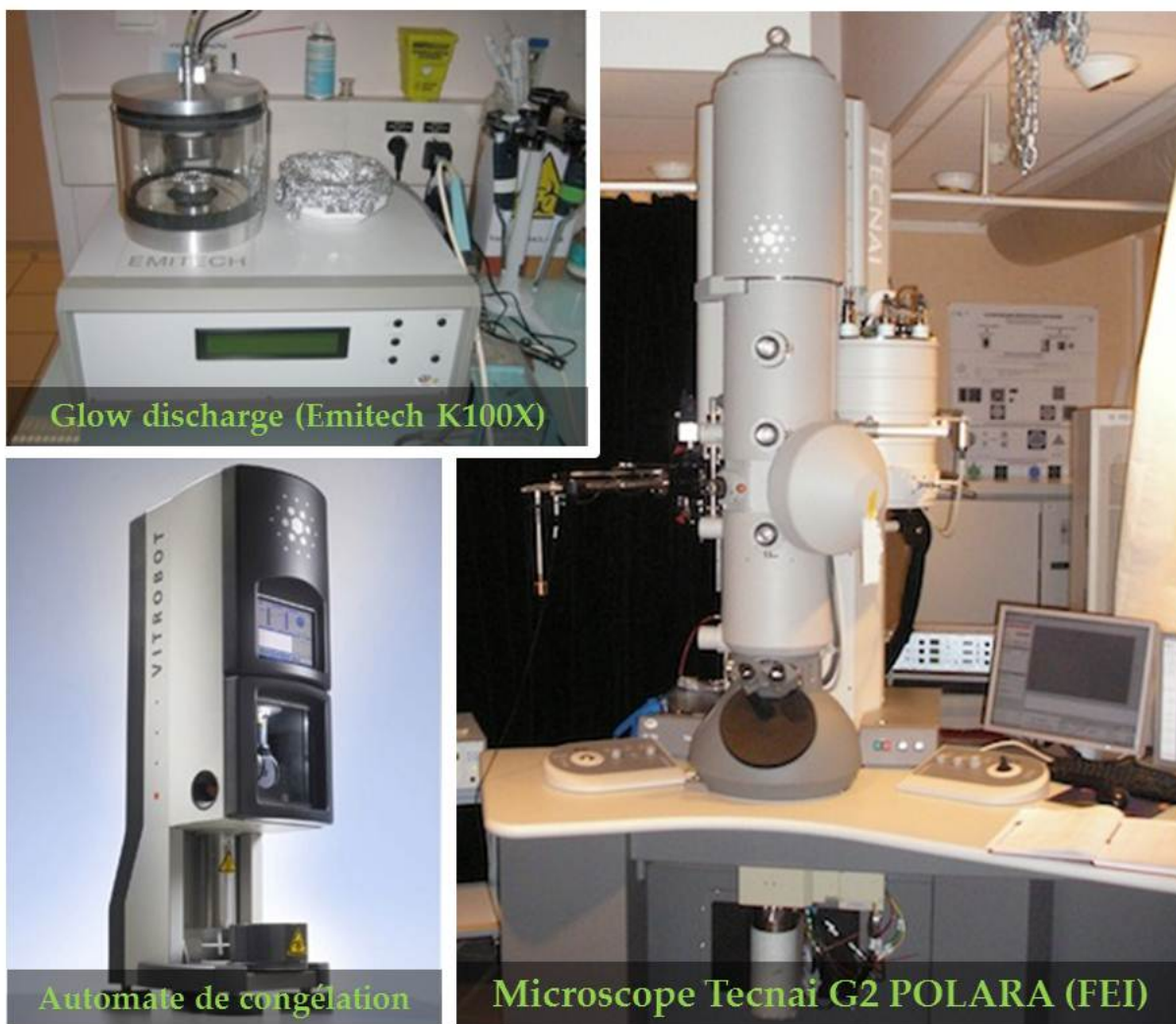
Fig. 2.2 – Montage expérimental utilisé pour les mesures cryo-TEM à l'IBS. En haut à gauche : Métalliseur pour l'ionisation sous plasma des grilles TEM. En bas à gauche : Dispositif Vitrobot (FEI) automatisé permettant la vitrification des suspensions dans l'éthane liquide. A droite : Microscope Tecnai G2 POLARA (FEI) [100].
