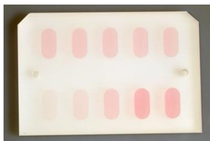
Figure 2-4: Photographie du fantôme contenant 5 inserts d'iode de 1 mg I/cm 2 (ligne supérieure) et 5 inserts d'iode de concentrations croissantes de 0,25 à 4 mg I/cm 2 d'iode (ligne inférieure de gauche à droite)
