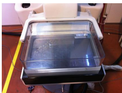
Figure 2-7: Photographie des acquisitions du fantôme CDMAM associé à 2 plaques PMMA de 2 cm d'épaisseur sur le Senographe DS ®
