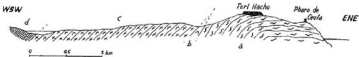
Figure 33 : Coupe de Ceuta selon Kornprobst (1962). a : orthogneiss du Monte Hacho ; b : écaille de péridotites ; c : unité supérieure de Ceuta ; d : micaschistes gris-jaunâtres.
