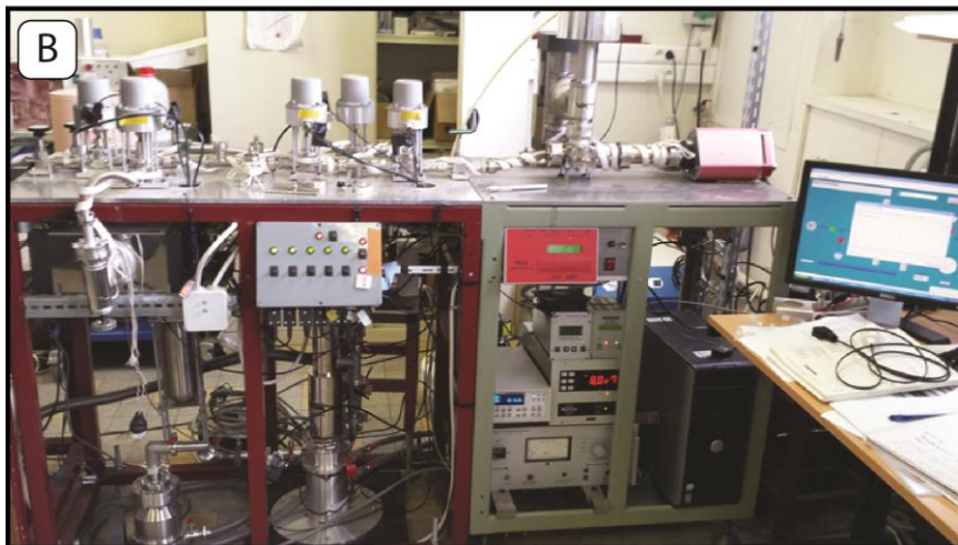
Figure 30 : A – Plan schématique de la ligne d'extraction de l'hélium. V1 à V6 correspondent aux différentes vannes qui contrôlent le pompage de la ligne ; B – Ligne d'extraction de l'hélium du laboratoire Géosciences Montpellier ; C – Porte-échantillon cuivre sous ultraviolet.
