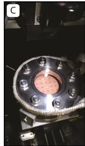
Figure 30 : A – Plan schématique de la ligne d'extraction de l'hélium. V1 à V6 correspondent aux différentes vannes qui contrôlent le pompage de la ligne ; B – Ligne d'extraction de l'hélium du laboratoire Géosciences Montpellier ; C – Porte-échantillon cuivre sous ultraviolet.
