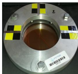
Figure III-4 Présentation des demi-coques de l'échangeur de chaleur avec ses trois cavités permettant l'ajout de hublots pour les mesures I-R.
