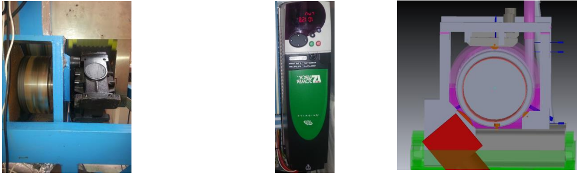
Figure III-9 Système d'entrainement du four rotatif.
