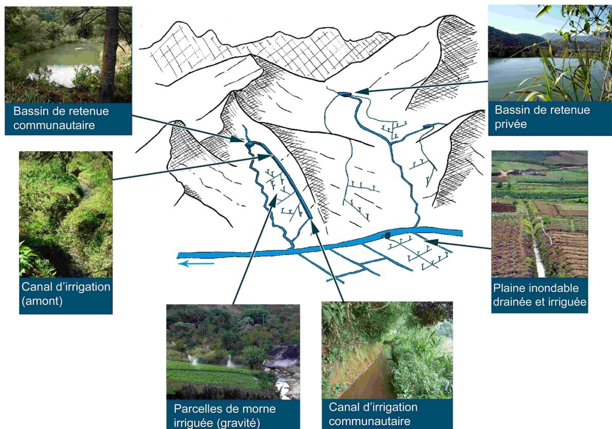
Figure 20 : Organisation de l'irrigation au niveau privé et communautaire (réalisation : auteur à partir des observations de terrain)
