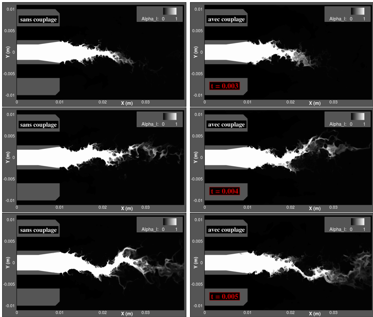
FIGURE 10.20 – Champs instantanés de la fraction volumique de liquide dans CHARME, pour t = 0.003 , t = 0.004 et t = 0.005 secondes. Comparaison des simulations S1 et S2 (sans et avec couplage).
