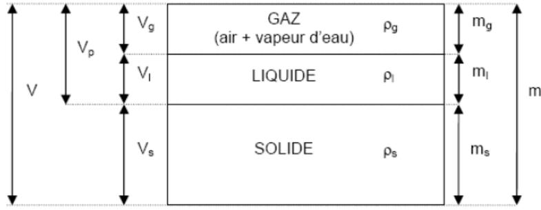
Figure I-4 : Phases d'un milieu poreux humide (Collet 2004)
