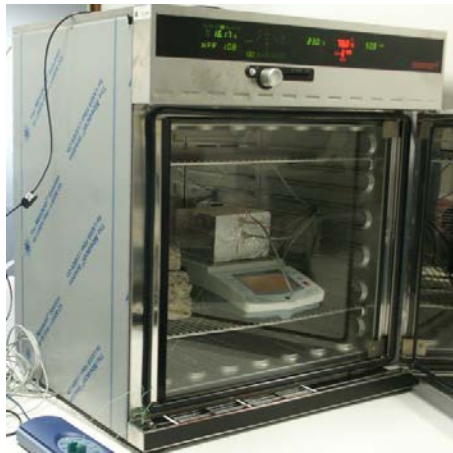
Figure III-2 : Enceinte climatique avec échantillon
