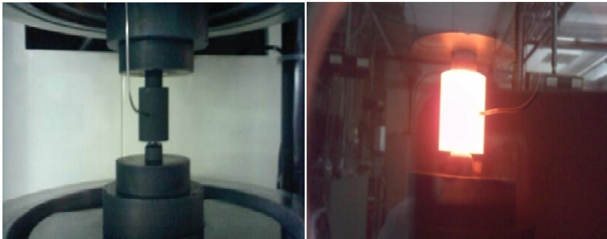
FIGURE 4.6 – Photos du moule de carbone contenant la poudre de ferrite, avant (à gauche) et pendant (à droite) le frittage.
