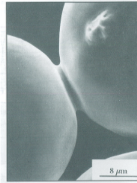
FIGURE 4.4 – Image par microscopie électronique à balayage de la formation d'un pont due au frittage de sphères de nickel ( 33 \mu\text{m} de diamètre) fritté à 1030^\circ\text{C} pendant 30 mn dans le vide. Photo tirée de Powder metallurgy science de Randall M. German [48].
