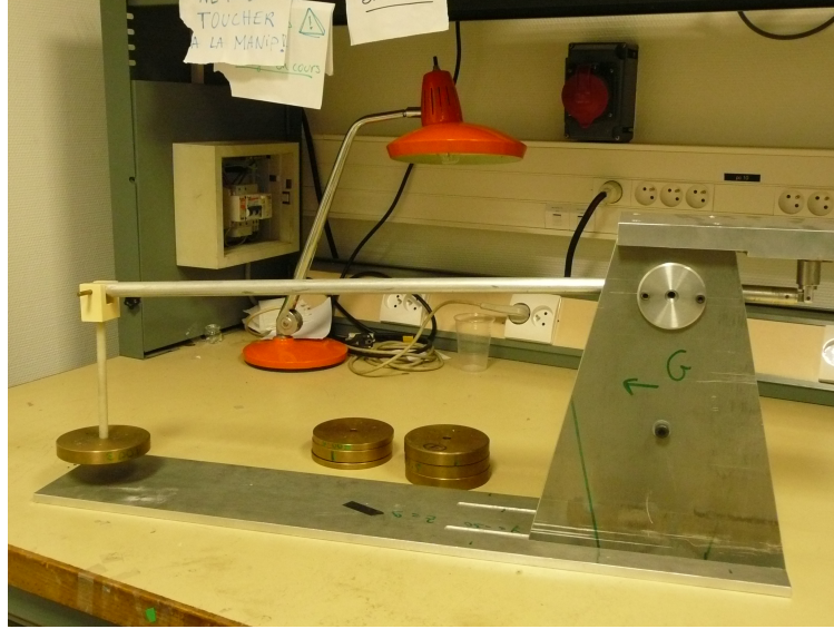
FIGURE 5.2 – Photographie de la presse permettant d'appliquer des contraintes uniaxiales sur les ferrites dont est testée la sensibilité de leurs propriétés magnétiques à la contrainte.
