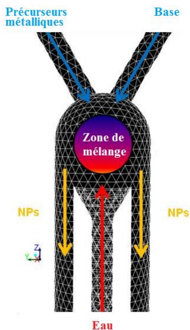
Figure 14 : Réacteur hydrothermal développé par l'équipe MaNaPI 100
