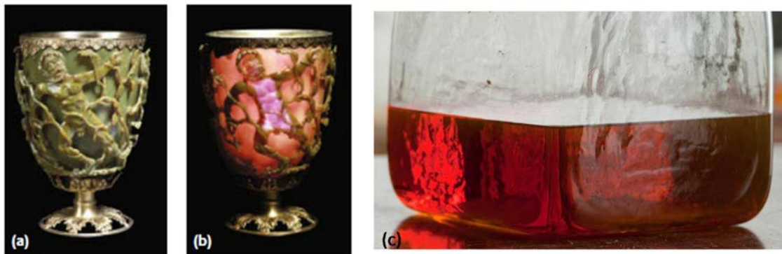
Figure 43 : Coupe de Lycurgue (a) en réflexion et (b) en transmission (Extrait de [97]). (c) Suspension colloïdale originale d'or par Michael FARADAY (Extrait de [98])
