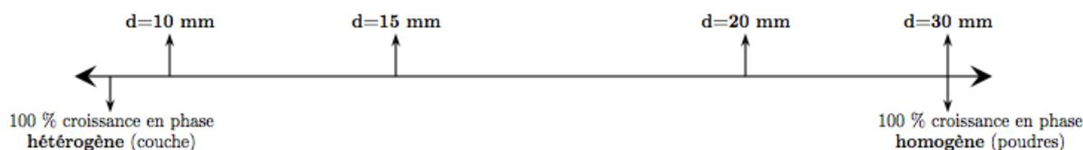
Figure 54 : Représentation schématique de l'équilibre entre les deux processus (croissance en phase homogène et en phase hétérogène) à l'origine des dépôts obtenus pour différentes distances torche – substrat ( $d=10\text{ mm}$  à  $30\text{ mm}$ ).
