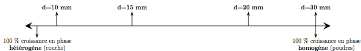
Figure 54 : Représentation schématique de l'équilibre entre les deux processus (croissance en phase homogène et en phase hétérogène) à l'origine des dépôts obtenus pour différentes distances torche – substrat (d=10 mm à 30 mm).
