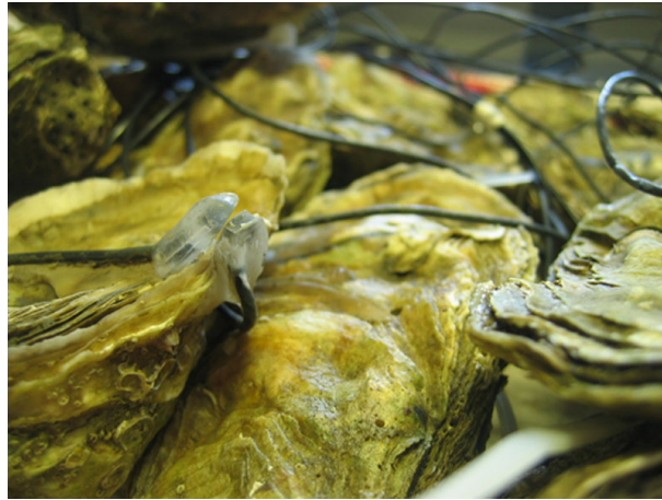
Figure IV.1 – Électrodes sur un groupe d’huîtres ( http://molluscan-eye.epoc.u-bordeaux1.fr/ ). Crédit photo Jean-Charles Massabuau.
