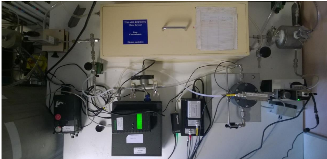
Figure 5-2 : Banc permettant la création d'atmosphère de thoron à forte activité volumique.
