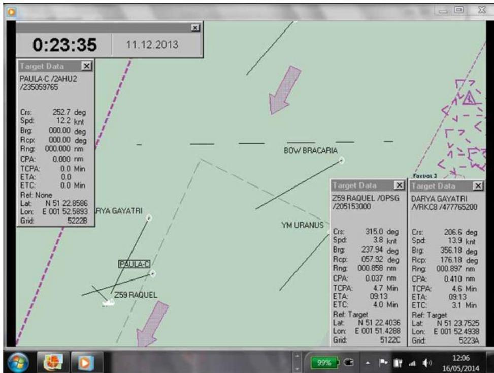
Figure 4-16. Ecran de contrôle en centre de surveillance, les navires Paula-C et Darya Gayatri en navigation proche et parallèle, navire Raquel en manœuvre d'évitement
