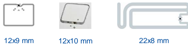
Fig. 1-10 – Exemples de tags RFID UHF spécialement conçus pour opérer dans la zone de CP-Re et leurs dimensions.
