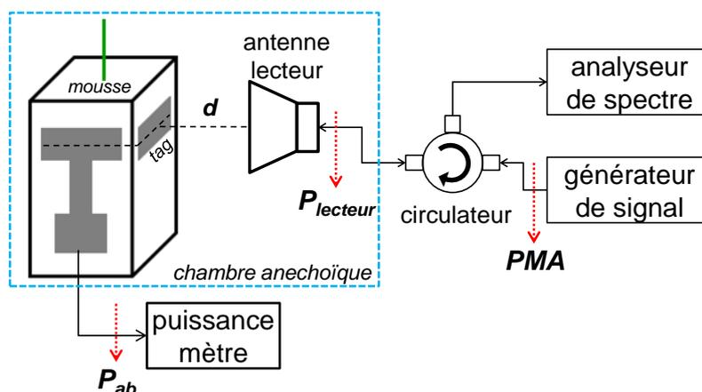
Fig. 4-11 – Schéma du banc de test [4.12].
