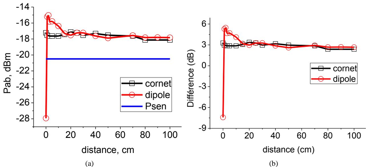
Fig. 4-16 – (a) Puissance reçue par le tag à 868 MHz comparée à la puissance  $P_{sensibilité}$  de la puce. En (b) la différence entre la puissance reçue et la puissance  $P_{sensibilité}$ .
