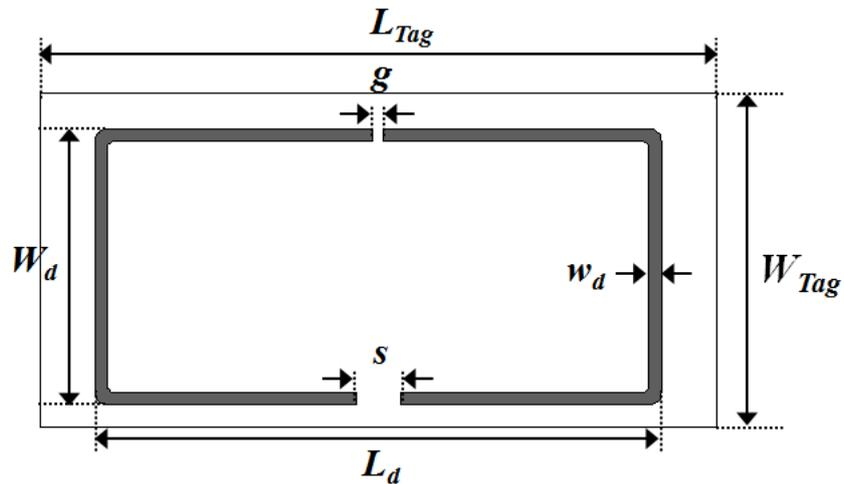
Fig. C-4 – Géométrie du tag « dipôle plié ».
