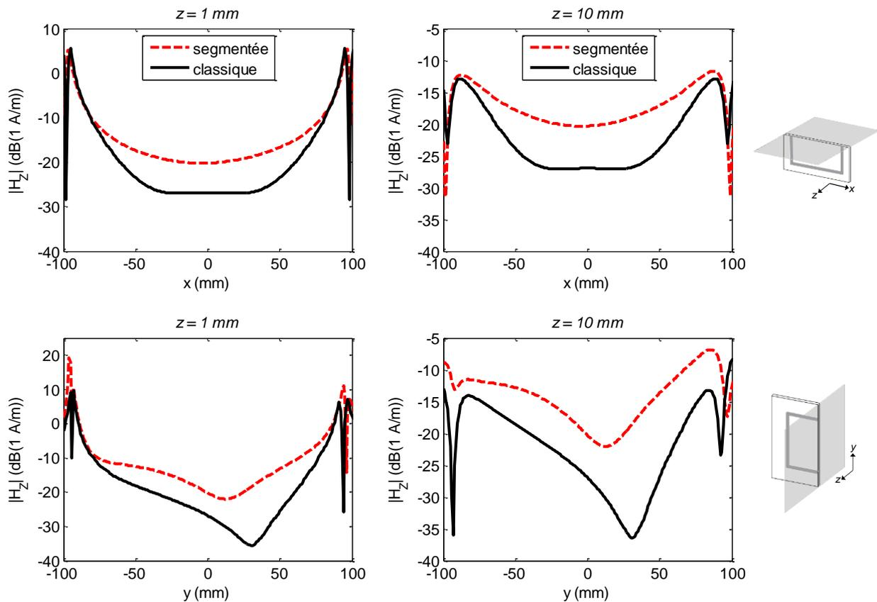
Fig. 2-9 – Comparaison entre le module simulé du champ magnétique d'une antenne boucle segmentée et d'une antenne boucle classique à la fréquence 868 MHz le long de l'axe- $x$  et de l'axe- $y$  pour les distances  $z = 1$  mm et  $z = 10$  mm.
