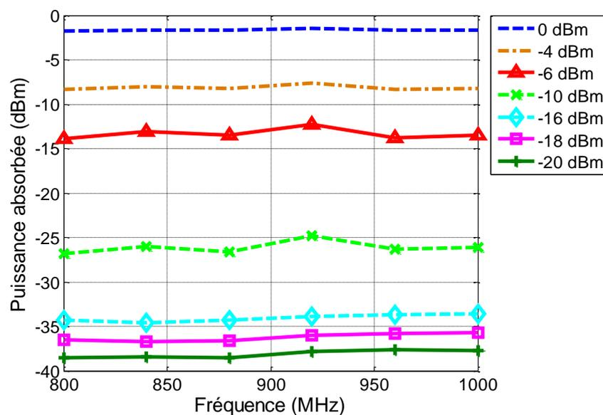
Fig. 3-16 – Puissance absorbée par la puce.
