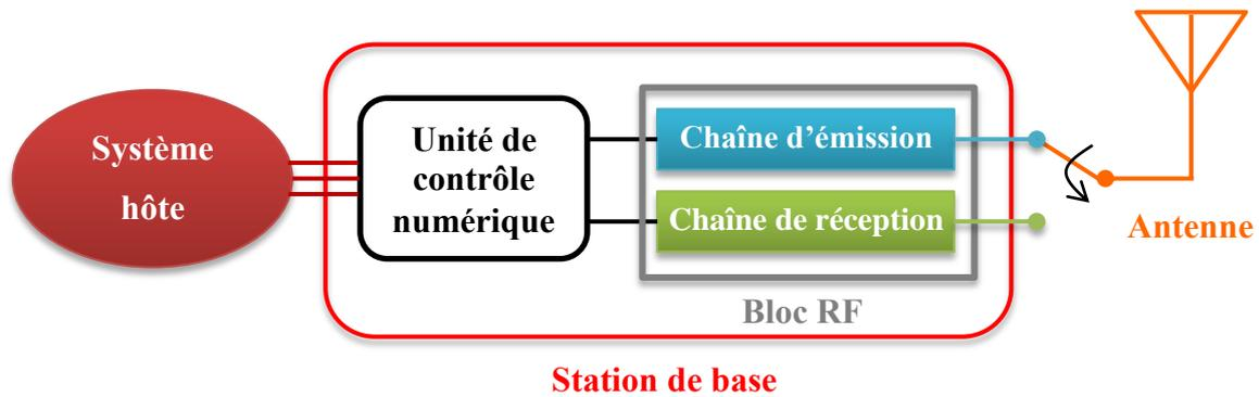
Fig. 1-2 – Schéma fonctionnel du récepteur RFID.
