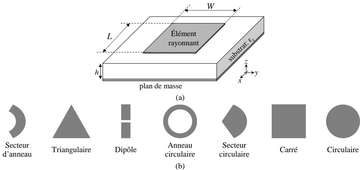
Fig. 2-14 – (a) Illustration de l'antenne patch rectangulaire en soulignant les quatre paramètres principaux de l'antenne : l'épaisseur ( $h$ ) et la constante diélectrique ( $\epsilon_r$ ) du substrat, la longueur ( $L$ ) et la largeur ( $W$ ) du patch. En (b) des exemples de formes que l'élément rayonnant peut avoir [2.1].
