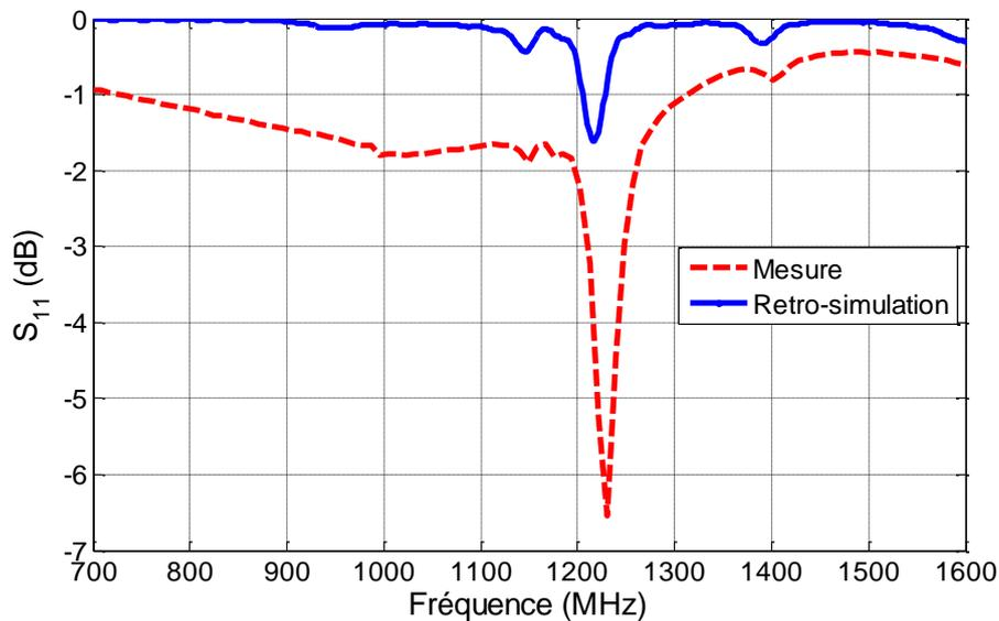
Fig. 2-18 – Comparaison entre les résultats de mesure et de rétro-simulation prenant en compte l'écartement entre les substrats.
