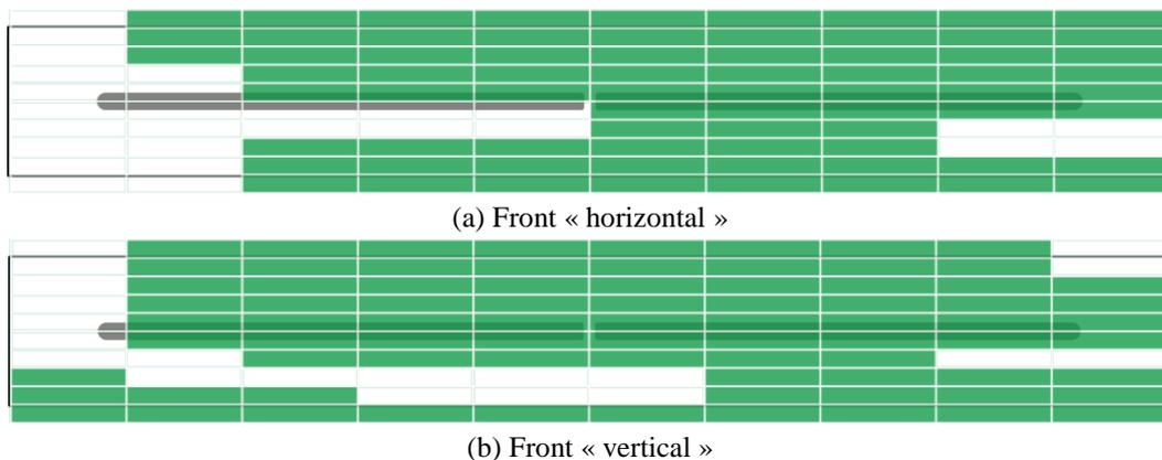
Fig. 2-36 – Cartographie dipôle avec tag ALN 9613 dans l'orientation (a) «front horizontal» et (b) «front vertical».
