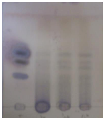
Figure 89: Suivi au cours du temps de la réaction d'autohydrolyse du xylane H 2 O à t0, t16h et t24h. A gauche : les références, de haut en bas : xylose, glucose, acide glucuronique, saccharose
