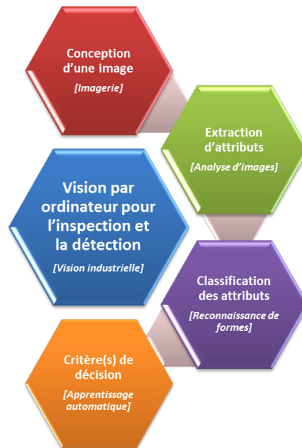
FIGURE 4 – Les quatre étapes clés d'un système d'inspection par vision artificielle
