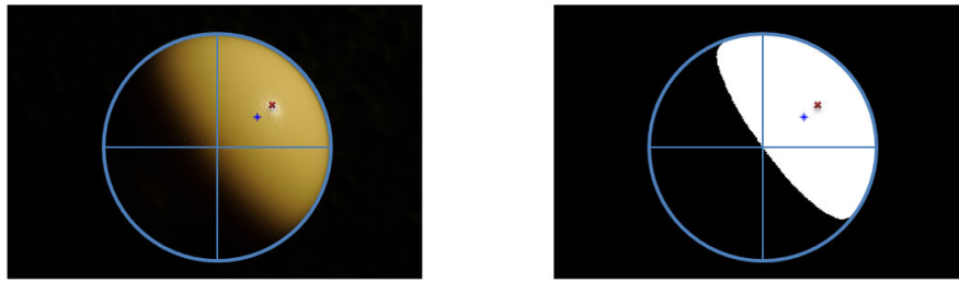
FIGURE 2.34 – La figure, correspondant à une photographie en vue de dessus, permet d’identifier le reflet (croix rouge) et le centre de gravité de la zone éclairée (croix bleue).
