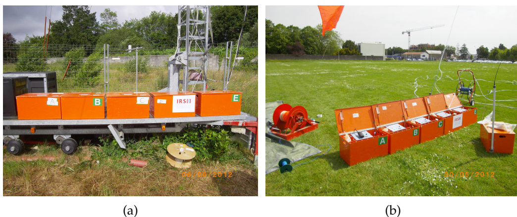
FIGURE 5.14 – Positionnement des DIAPEG sur le site Goss. a) au pied du mât pour des mesures en altitude sur le mât. b) près du treuil du ballon pour des mesures en altitude sous le ballon.
