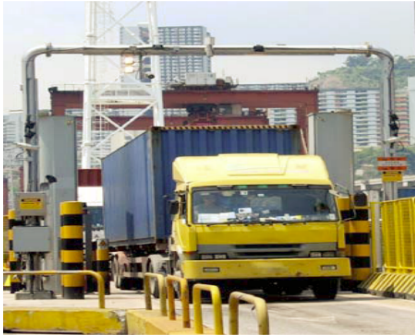
FIGURE 4 – Système d'inspection intégré de conteneur SAIC
