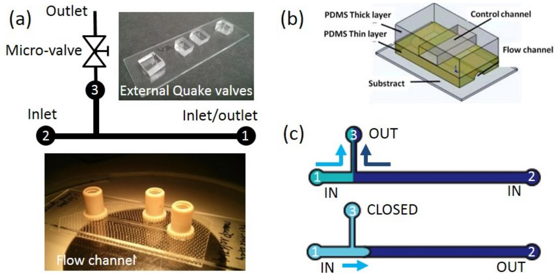
**FIGURE E.4** – Dispositif expérimental pour l'étude de déplacements de fluides. (a) Schéma de l'expérience, image du canal en verre fabriqué avec la colle NOA. (b) Dans la vanne Quake, le canal de contrôle de la vanne se situe au-dessus du canal d'écoulement et peut boucher ce dernier quand il est pressurisé. Reproduction de [166]. (c) Séquence des fluides pour l'initialisation de l'expérience de déplacement.
