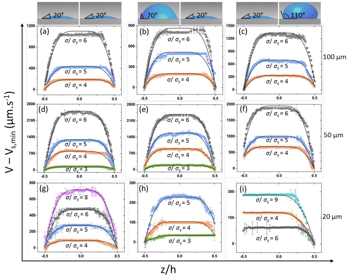
**FIGURE E.5** – Profils de vitesse  $V$  auquel est soustraite la vitesse de glissement  $V_{s,min}$  pour les différentes hauteurs, conditions de surfaces et contraintes appliquées  $\sigma/\sigma_y = 9$  (cyan foncé), 8 (pourpre), 6 (gris), 5 (bleu), 4 (rouge), 3 (vert). Les lignes continues sont les fits de l'expression théorique des profils de vitesse calculées avec le modèle de Herschel-Bulkley asymétrique présenté au paragraphe 4.2.
