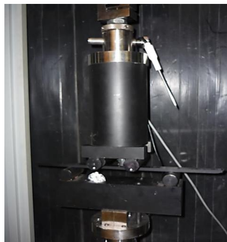
Fig. 5.9. Montage expérimentale – détection des défauts au fléchissement en quatre points par thermographie infrarouge.
