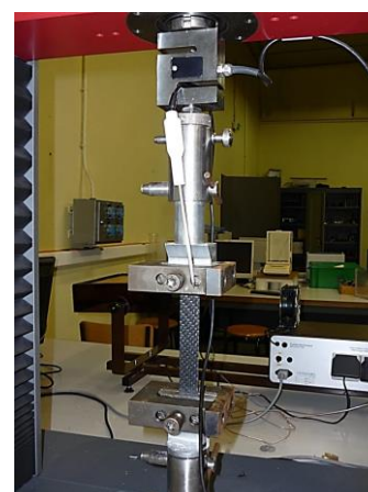
Fig. 5.10. Montage expérimentale pour la détection des défauts à la traction par thermographie infrarouge.
