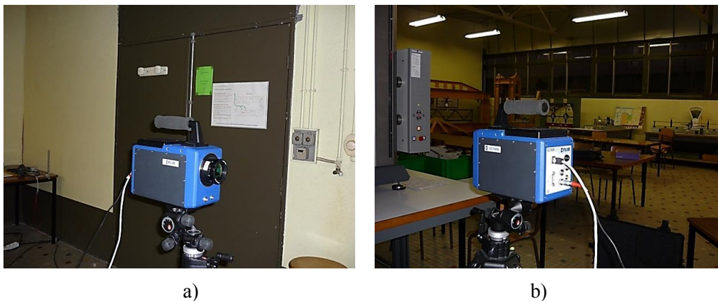
Fig. 5.12. Detalii camera de termografie în infraroșu: față (a), spate (b).
