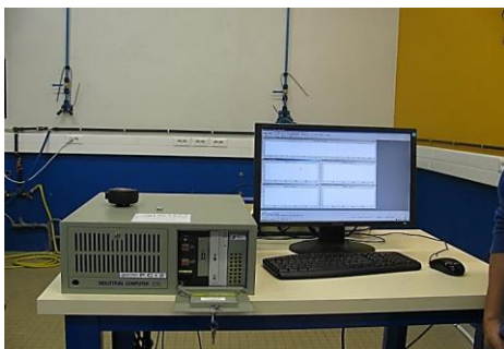
Fig. 5.5. Système de détection des microfissures basé sur la méthode d'émission acoustique.
