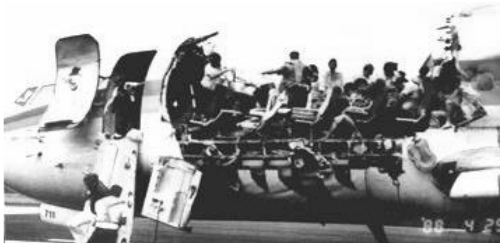
Fig. 2.4. Accidentul zborului 243 al companiei Aloha Airlines din 29 aprilie 1988 datorat coroziunii insuficient controlate în etapa de mentenanță, după [Balageas et al., 2010].
