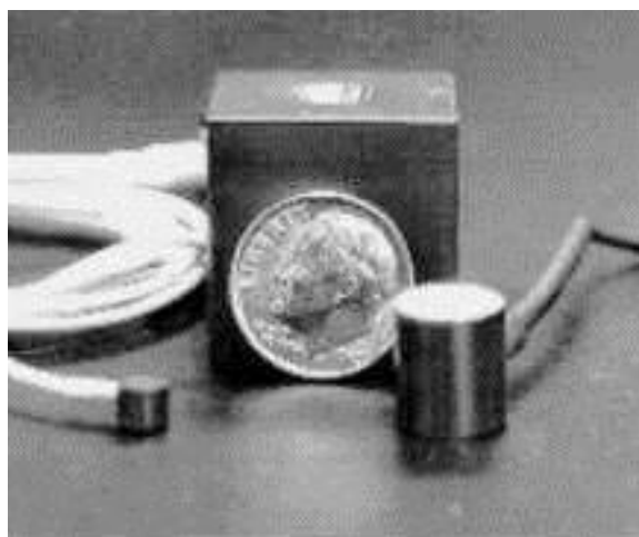
Fig. 2.6. Senzor de emisie acustică utilizat în cadrul sistemului SHM montat în structura elicopterului, după [Cazangiu & Roșca, 2013].
