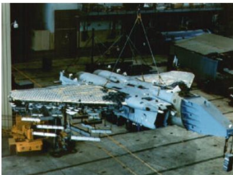
Fig. 2.7 Utilizarea metodei de emisie acustică ca metodă SHM pe un avion de luptă supus unor teste de oboseală, după [Cazangiu & Roșca, 2013].
