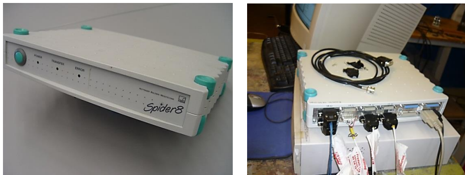
Fig. 5.4. Plaque d'aquisition SPIDER 8.
