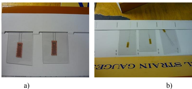
Fig. 5.15 Mărci tensometrice utilizate pentru determinarea deplasărilor în cazul încercării epruvetei la încovoierea în 4 puncte: tip N11 – FA – 8 – 350 – 11 (a); tip N11 – MA – 5 – 120 – 11 (b).
