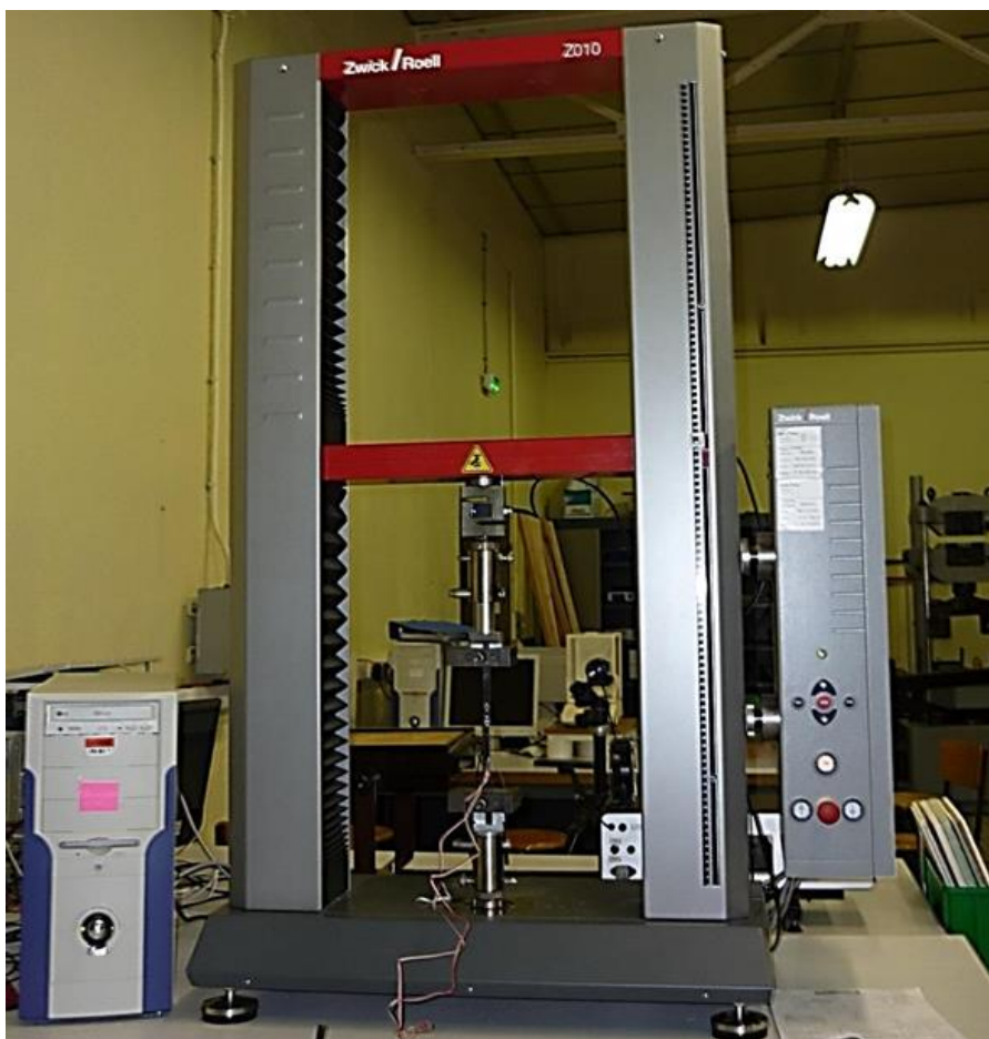
Fig. 5.9. Mașina de încercări la tracțiune/compresiune tip ZWICK/ROELL Z010.
