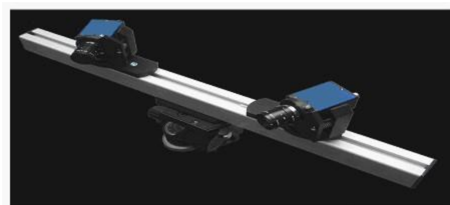
Fig. 2.32. Montaj realizat pentru detectarea defectelor prin metoda corelării imaginilor video, după [Szava et al., 2013].
