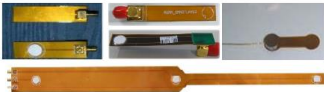
Fig. 2.8. Pelicula de senzori PZT, după [Cazangiu & Roșca, 2013].
