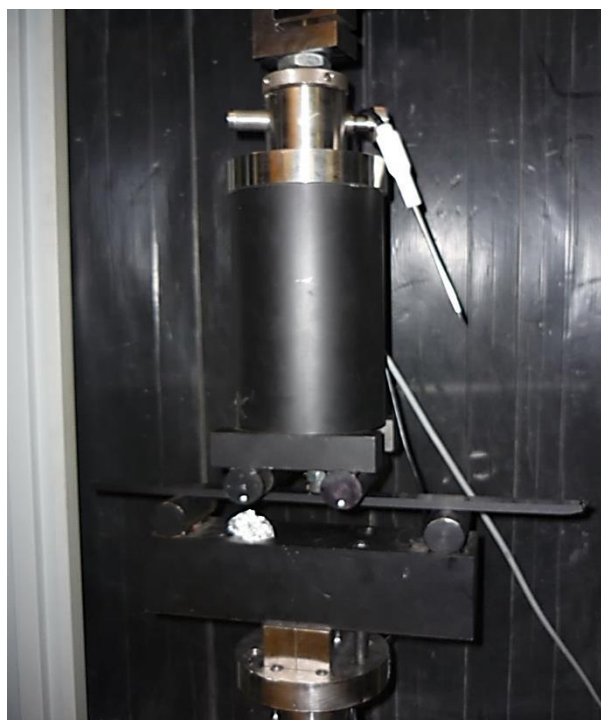
5.13. Montaj experimental – detectarea defectelor la încovoierea în 4 puncte prin termografia în infraroșu.
