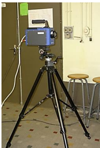
Fig. 5.8. Caméra thermographique infrarouge SC FLIR 7000.
