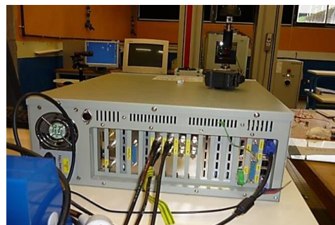
Fig. 5.5. Système de détection des microfissures basé sur la méthode d'émission acoustique.
