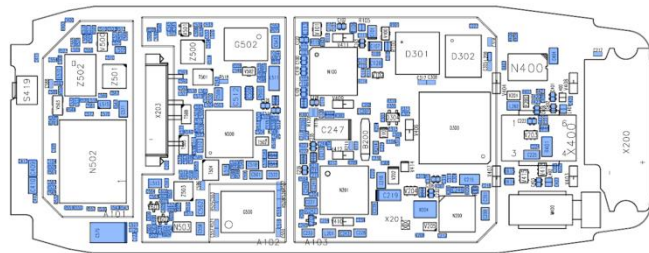
Figure I.1 : Schéma de la carte mère d'un téléphone mobile Nokia 3310. Les composants passifs sont surlignés en bleu. (source : www.nokia.com )
