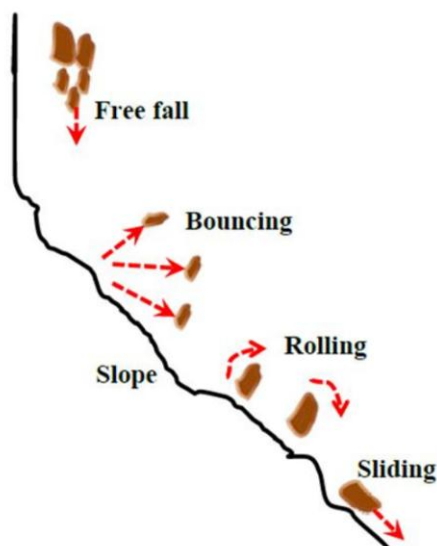
Figure 1.13. Description des mécanismes de propagation (Basson, 2012)
