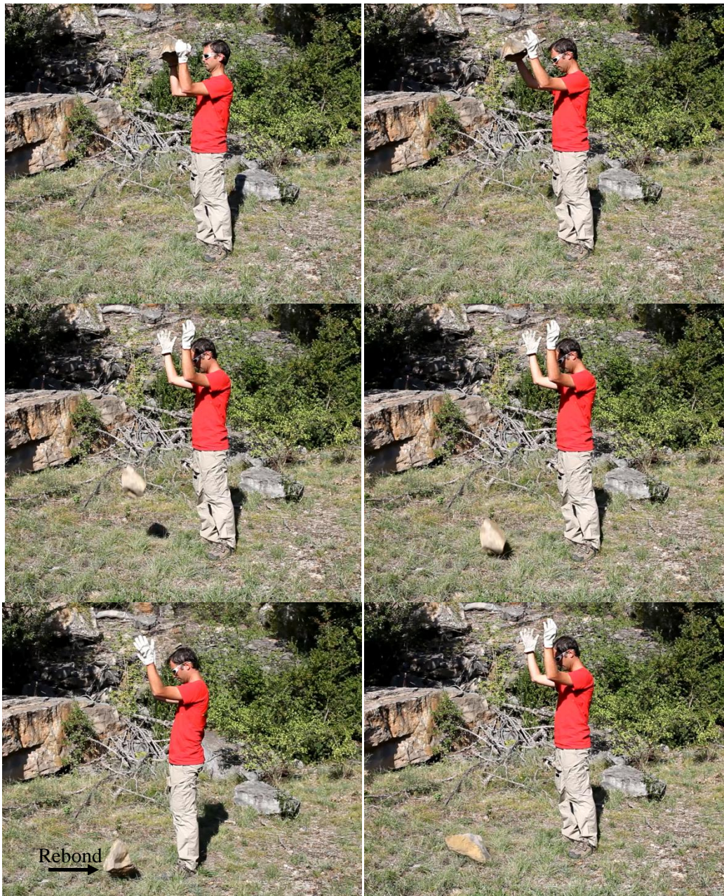
Figure 5.2. Exemple de lâcher d'un bloc rocheux sur le sol. Le terrain choisi pour l'expérience contient très peu de végétation pour en négliger l'effet. Le bloc rebondit à une hauteur d'environ 15 à 20 % de sa hauteur initiale (repérée par la flèche noire sur la figure en bas à gauche)
