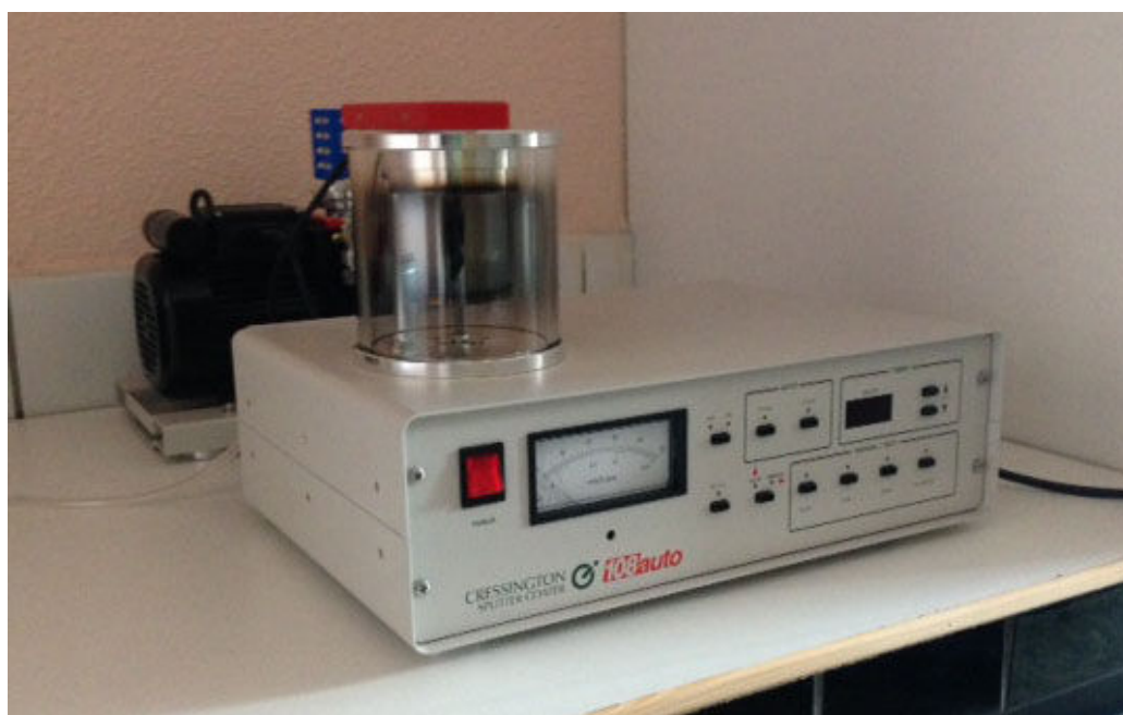
Figure 21: Métalliseur Cressington 108auto/SE muni de sa pompe Duo Line
