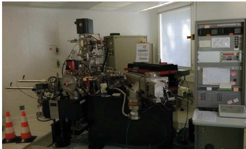
Figure 3-1. Le NanoSIMS-50 au LMI de l'Institut Curie d'Orsay.
