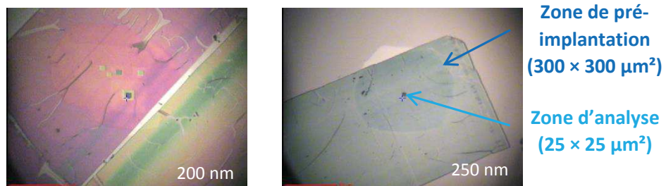
Figure 4-3. Photos de films de PS-8 déposés sur une plaquette de silicium prises par la caméra CCD du NanoSIMS. On peut y voir la zone de pré-implantation (300×300 μm 2 ) et les cratères d'analyse (25×25 μm 2 ) (voir Partie 4.1.5).
