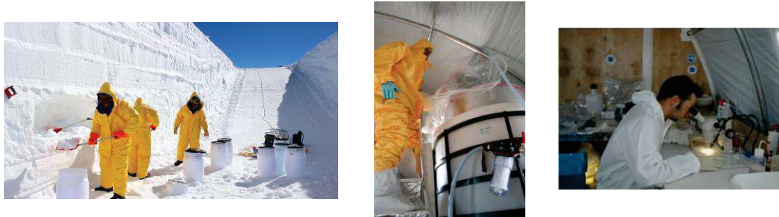
Figure 1-22. À gauche, collecte de la neige dans une tranchée de 5 m de profondeur (âges terrestres ~ 50 ans). Au milieu, la neige est fondue dans un fondoir à double cuve inox. À droite, les filtres sont pré-examinés sur le terrain pour collecter les particules > 20 µm.
