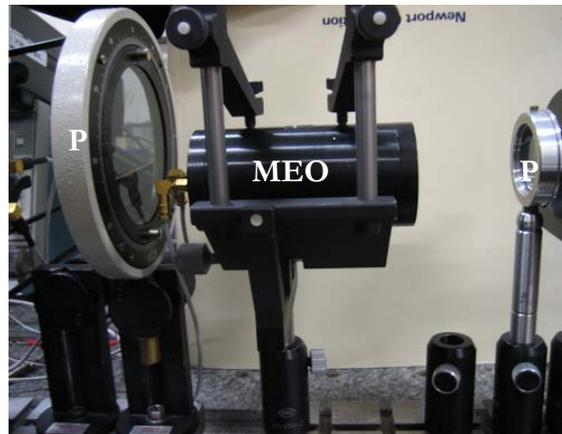
**Fig. 2.9** Caractérisation du modulateur électro-optique (MEO), P : polariseur
