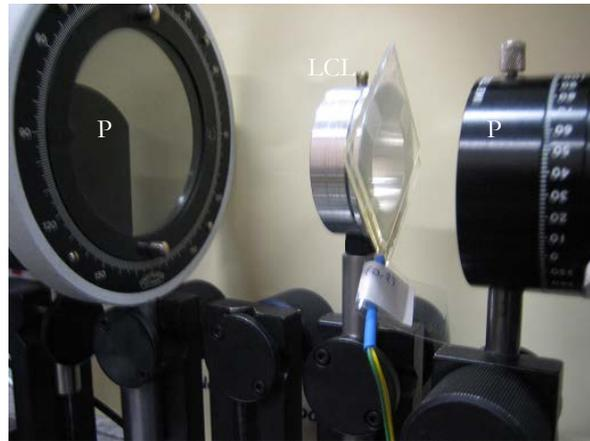
**Fig. 2.6.** Caractérisation d'une lame à cristaux liquide (LCL), P: polariseur
