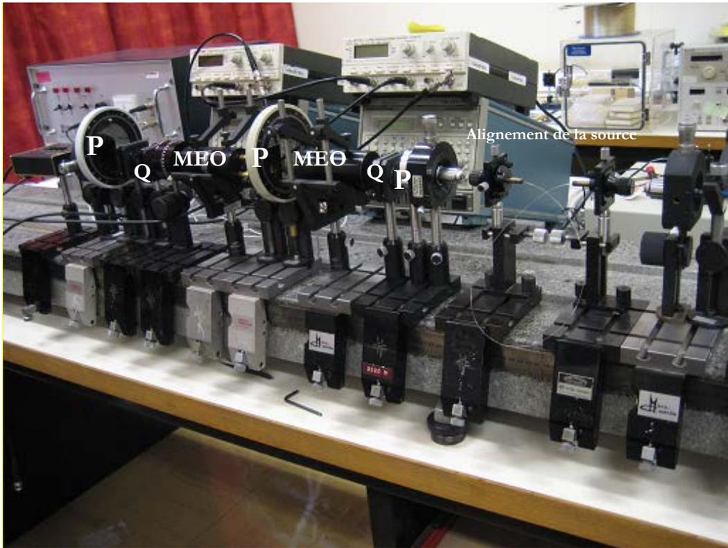
**Fig. 2.11.** Architecture expérimentale de la mise en œuvre de l'architecture de traitement d'ordre 2
