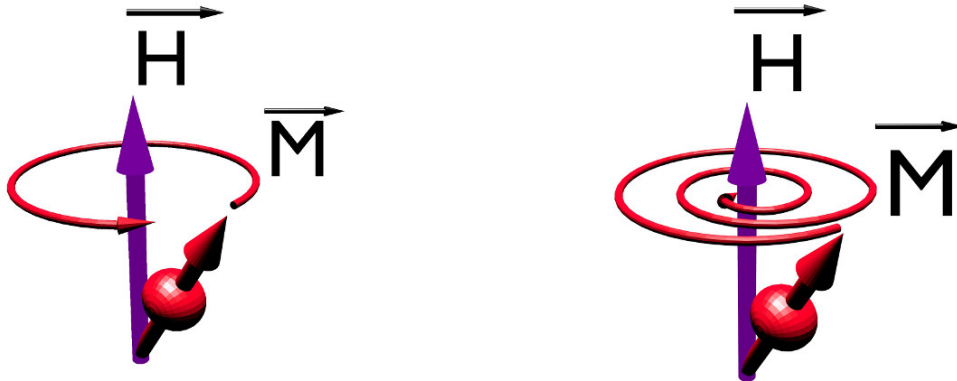
(a) En l'absence d'amortissement, la trajectoire prise par un moment magnétique est une précession autour du champ magnétique effectif. (b) En présence d'amortissement, la précession du moment magnétique est amortie et \vec{M} finit par s'aligner avec \vec{H}_{eff} .
