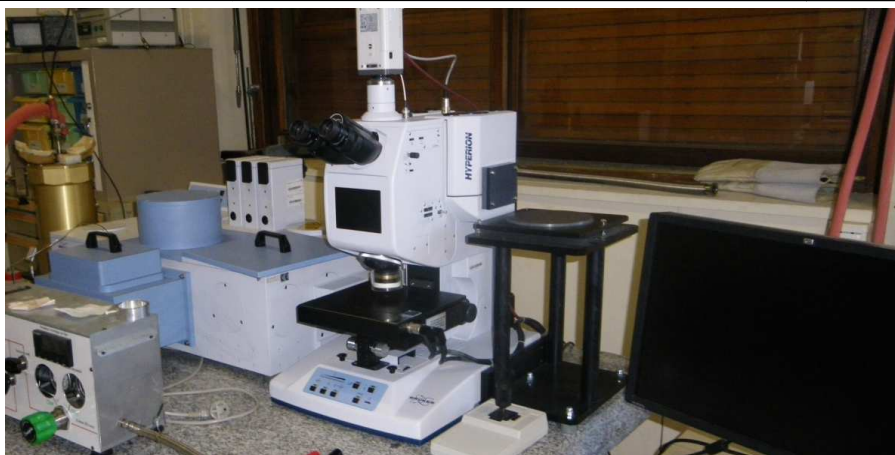
Figure II.31 : Spectromètre FT-IR Bruker IFS66V/S
