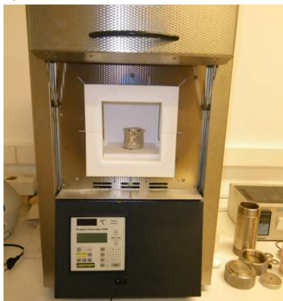
Figure II.11 : Four Nabatherm LHT 04/17 avec creuset de platine
