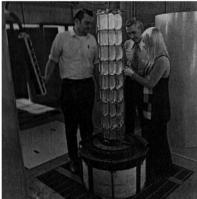
Figure II.1 : Fabrication industrielle de quartz chez Bell 114
