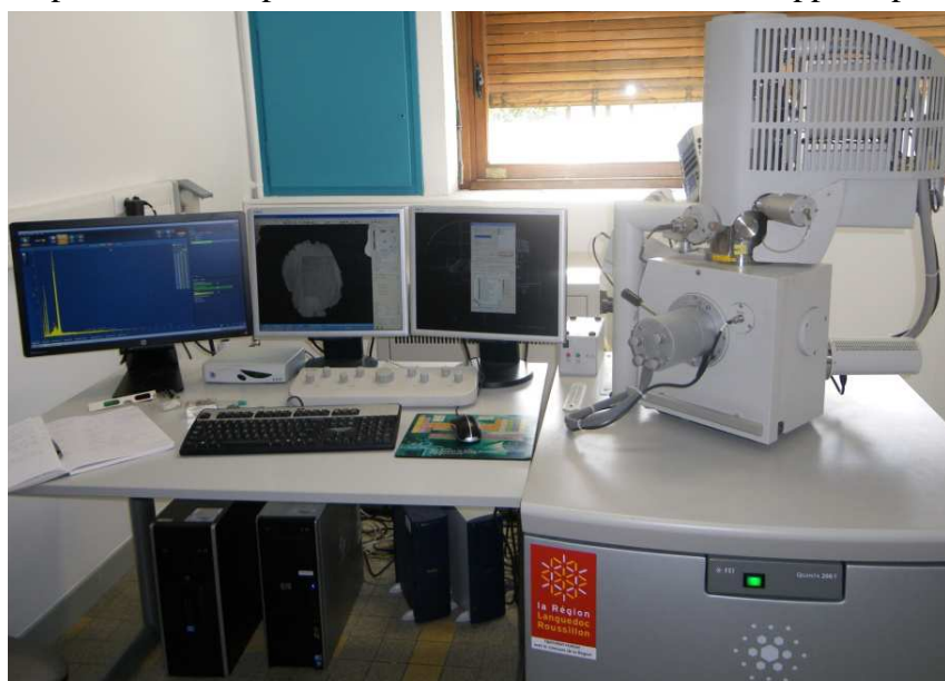
Figure II.22 : MEB avec analyseur EDS et son poste de pilotage
